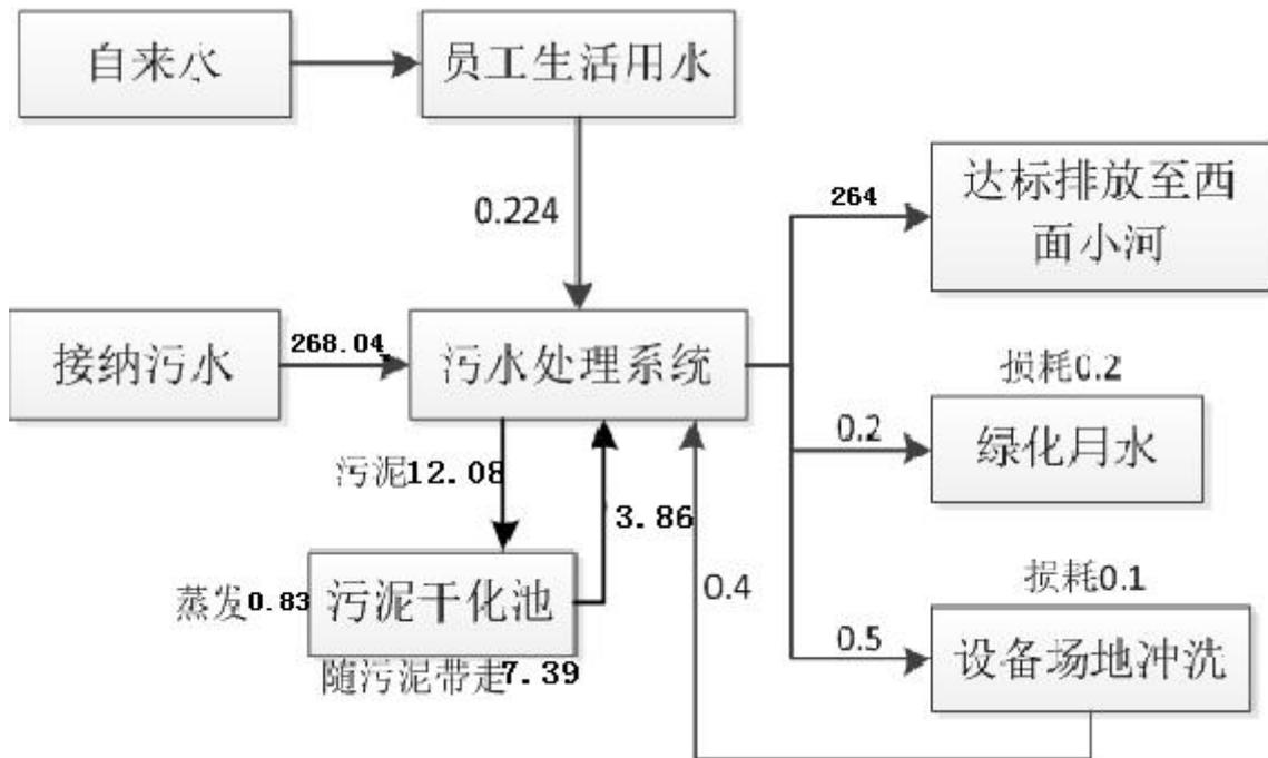
图 2-1 项目水平衡图（以监测当天流量计算，m³/d）
