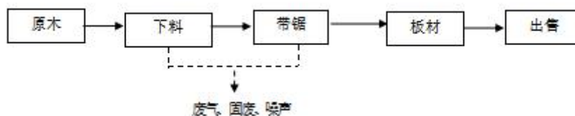
图 2-2 工艺流程和产污环节示意图
