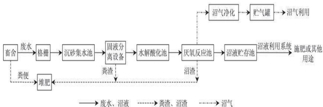
图 2.6-5 模式 II 基本工艺流程
