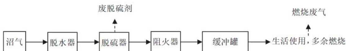
图 2.6-9 沼气净化工艺流程图
