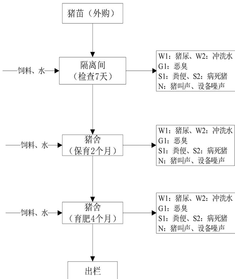
图 2.6-2 饲养工艺流程及产污位置示意图
