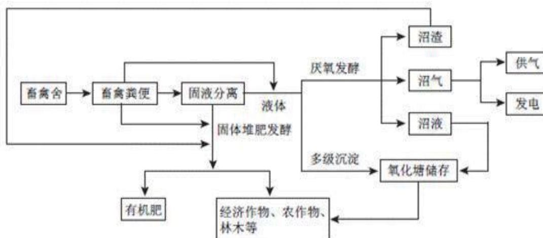
图 2.6-7 农业部推荐种养循环基本工艺流程
