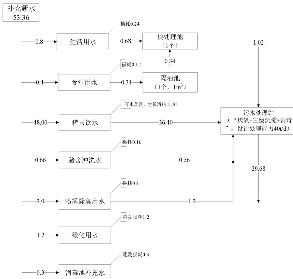
图 2.4-2 春、秋、冬季全场水平衡图 (单位: m<sup>3</sup>/d)
