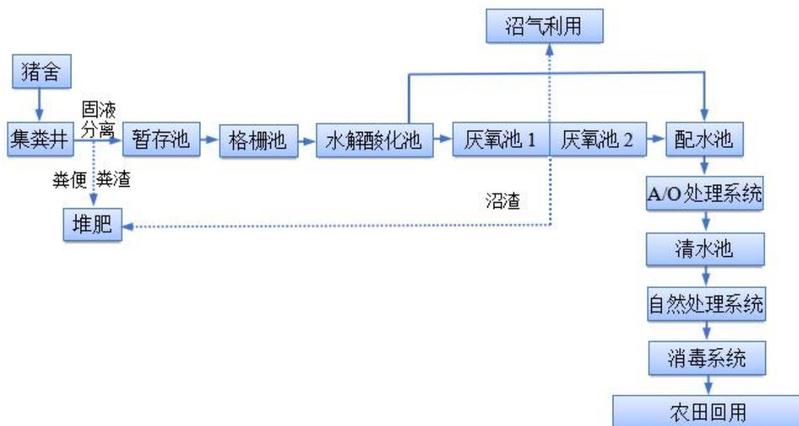
图 2.6-8 污水处理站工艺流程图
