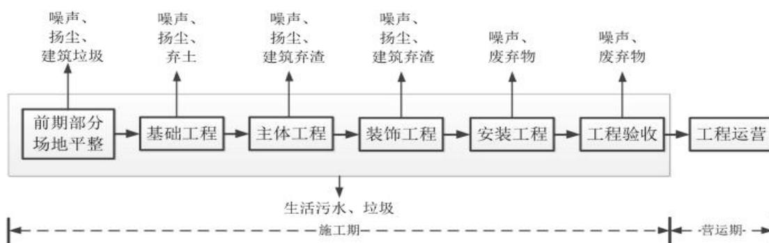
图 2.6-1 施工期工艺流程及产污位置示意图
