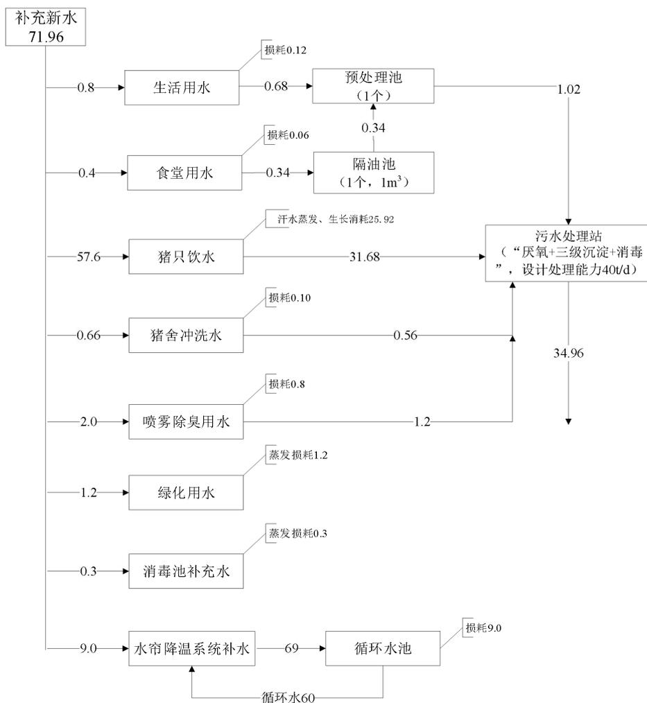
图 2.4-1 夏季全场水平衡图 (单位: m³/d)
