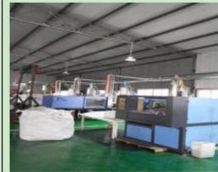
注塑机及废气收集管道
